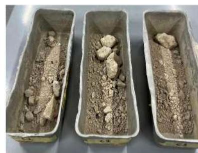
(d) Heated crushed concrete
